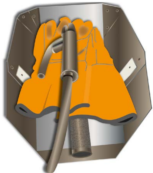
Abb. 58 Isolierte Ablage des Stabelektrodenhalters
