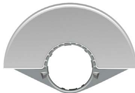
Abb. 64 Beidseitig abdeckende Schutzhaube für Winkelschleifer (empfohlen für das Trennschleifen mit kunstharzgebundenen Schleifscheiben)
